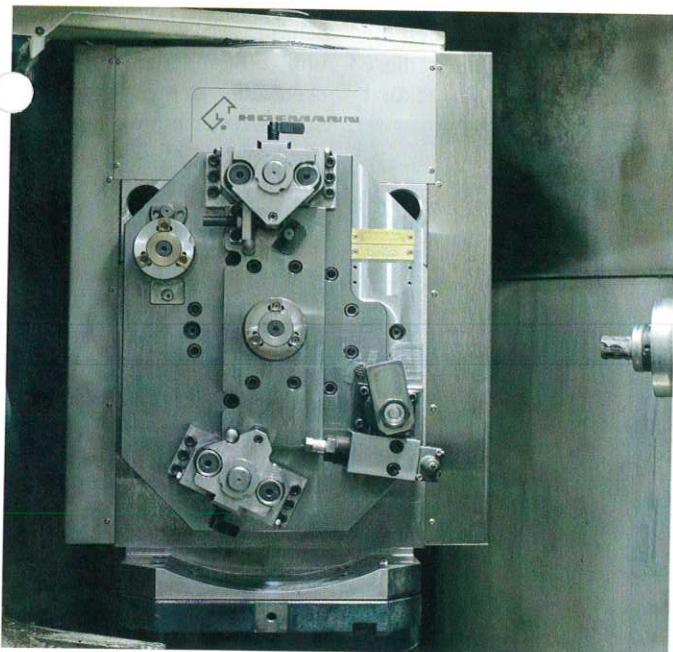
Die Bearbeitung des ersten Werkstückes erfolgt in der ersten Vorrichtung. Nach Fertigstellung wird das Teilgerät zur Bearbeitung des zweiten Werkstückes um 180 Grad geschwenkt.
